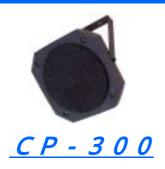
2本の配線にて映像が送れます。 ツイスト線以外に平行線でも映像が送れます。 伝送距離300m(最大600m) 受信機はNM-RX1001A 裏面参照
