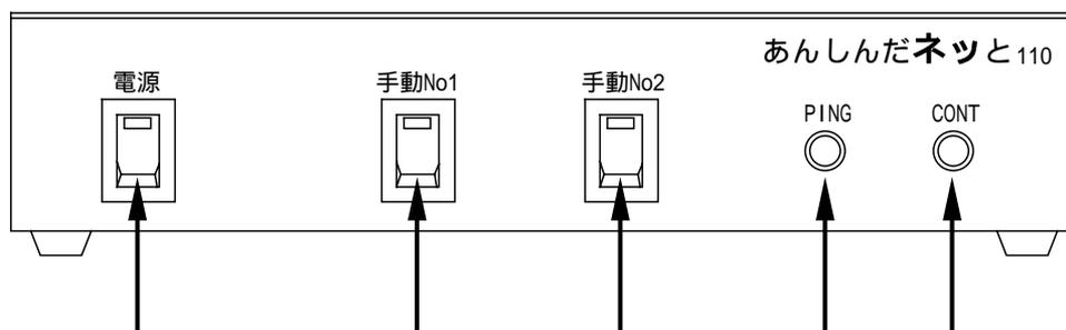
電源スイッチ ( 機器本体 通電時にLEDランプ 緑点灯 )
